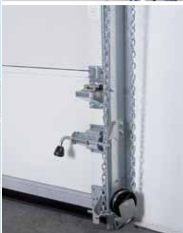
Ročno verižno dviganje, prenos 1 : 1 Enostavna, robustna konstrukcija s samozapornim potisnim zapahom.
