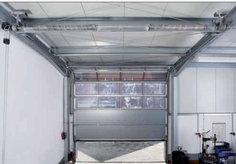
Sekcijska vrata SLW, vodila za nizko preklado z zadaj nameščeno vzmetno gredjo, višina preklade nad 270 mm, potrebujejo zelo malo prostora ob strani.
